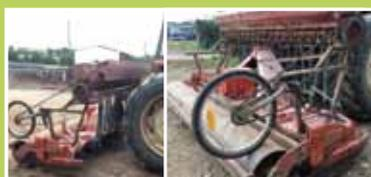
Entraînement du semoir par le rouleau, via la roue de vélo et la chaîne
